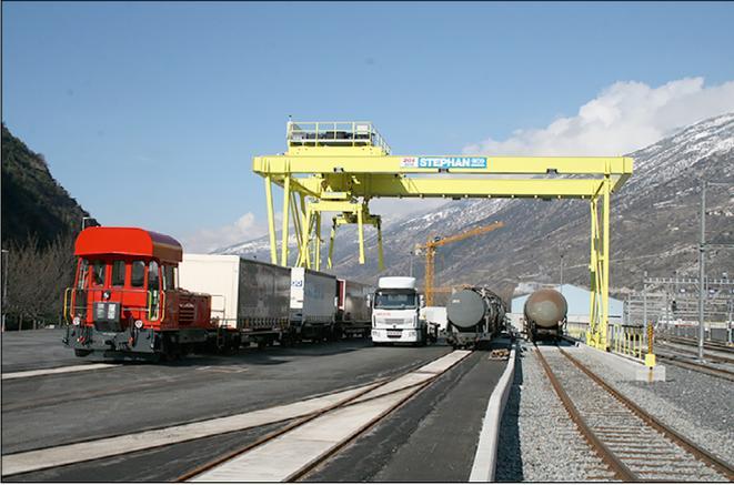
Umladeanlage zwischen Bahn (Normal- und Meterspur) und Strassenfahrzeugen mit dem 30t-Portalkran.
